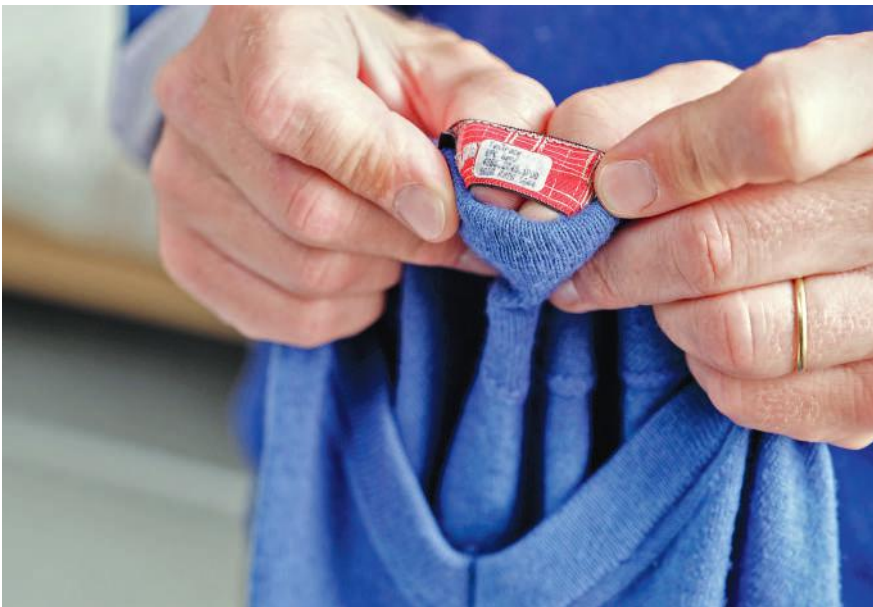
In jedem Kleidungsstück, das im intelligenten Kleiderschrank aufbewahrt wird, ist ein Chip eingewebt. So weiss der Schrank stets, wo genau sich welcher Pullover oder welche Hose befindet.
